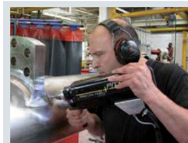
▲► Bild 11. Flächige PIT-Behandlung einer kompletten Schweißnaht der Rührwerkswelle (Bilder: Gerster)
