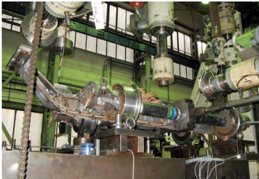
▲ Bild 9. Der Fahrwerksrahmen wurde auf einem Prüfstand Schwingungsversuchen unterzogen.
