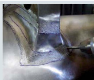
▲ Bild 10. PIT-Behandlung einer etwa 8 m langen Rührwerkswelle mit einem Durchmesser von etwa 300 mm
