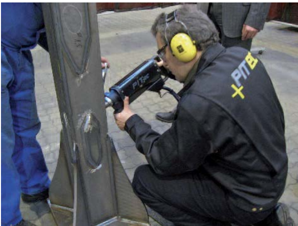
Bild 2. An den hochbeanspruchten Bohrungen dieses Strangpressen-Laufholms traten Risse auf.
